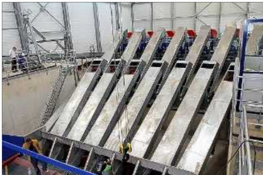
Le centre de tri des sacs verts, oranges et bleus de Morsbach sera le plus important avec sept lignes permettant d'identifier et d'orienter les sacs selon leur couleur.
